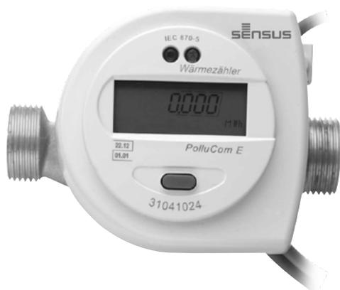
La quantità di calore fisico viene calcolata in base alla quantità di acqua fluita e alla differenza di temperatura tra flusso di mandata e di ritorno. Per misurare le temperature di mandata e di ritorno vengono utilizzate sonde di precisione (PT1000). Il microprocessore viene alimentato da una batteria al litio.
