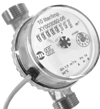
Contatore a turbina multigetto dotato di lancetta con magnete e di un emettitore d'impulsi inserito nella calotta.
